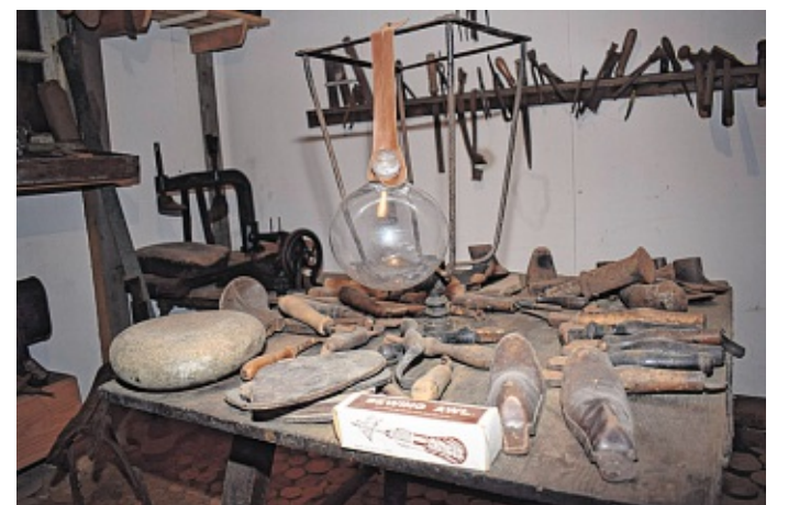
Die Schusterkugel ermöglichte Präzisionsarbeit auch bei schwachem Licht
