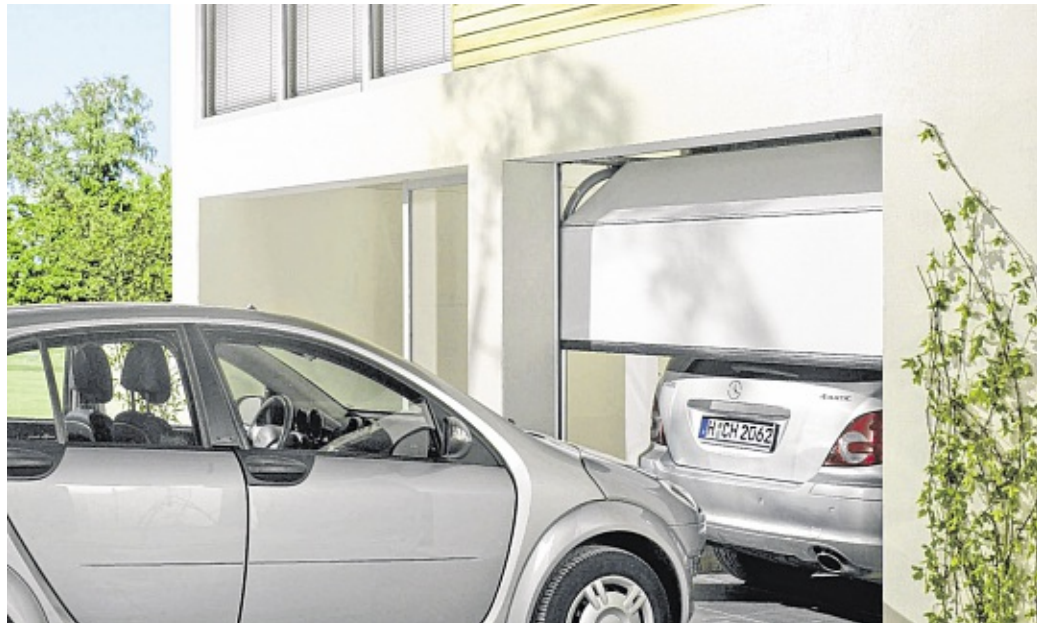
Bei sogenannten Sectionaltoren öffnet sich das Tor nach oben und fährt unter die Decke. So kann vor der Garage ein weiteres Fahrzeug abgestellt werden und das Tor lässt sich trotzdem öffnen.
